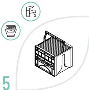
Die Filtereinheit kann unter laufendem Wasser abgespült oder in der Spülmaschine gereinigt werden.
